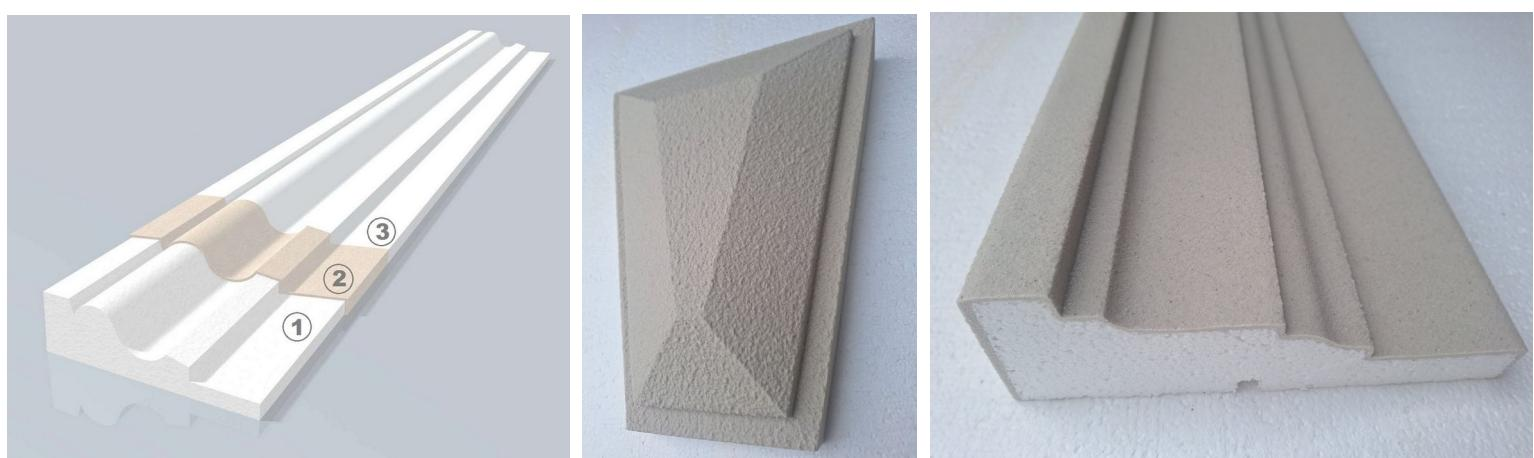
Prvky a profily jsou tvořeny polystyrenovým jádrem z EPS 150S (1) opatřeným fasádním omítkovým povrchem (2). U profilů se jedná o tažený povrch zrnitosti 0,2–0,4mm (štukový vzhled). U dekoračních prvků, kde je povrchová úprava provedena nástříkem, je zrnitost cca. 0,4–1,5mm (vzhled krupice, pemrlovaného kamene). Nátěr se provádí fasádní elastickou barvou (3).
